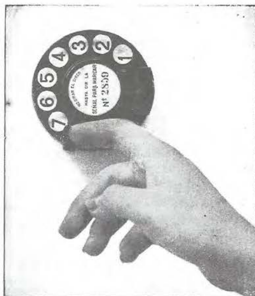
7. y haciendo girar el disco hasta llegar con el dedo al tope de parada. Después se retira el dedo.
