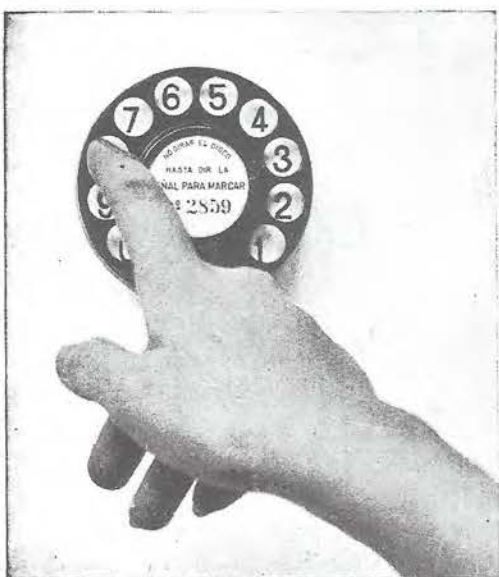
6. Luego se marca la cifra 8, introduciendo el dedo en el agujero correspondiente a la misma
