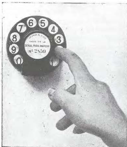
4. Supongamos que se trata del número 2859. Se introduce el dedo verticalmente en el agujero correspondiente a la cifra 2.
